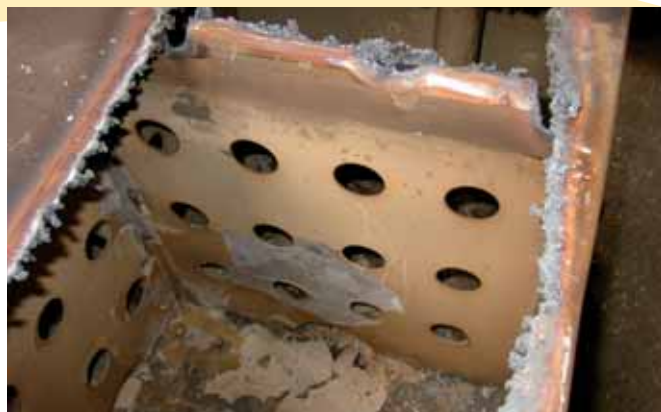
Usazeniny a zbytky na stěnách a dně vodní nádrže – Zdroj: ISPESL.
